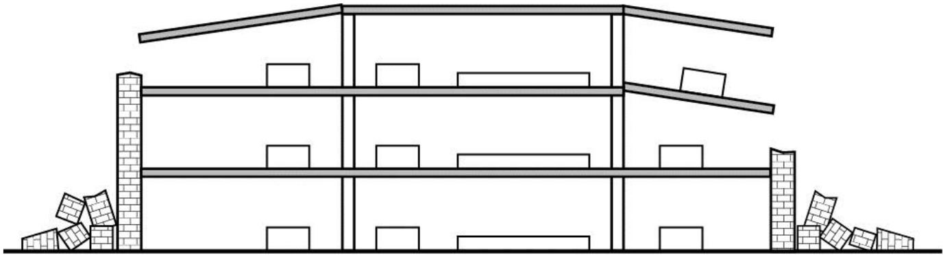
Figura D.2 (c) Modelo de la pared-Fall Collapse - Wall pesado - Tilt-Up de construcción.
